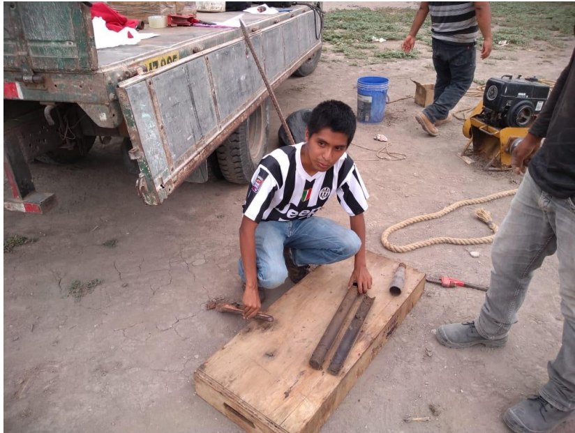
Fotografía 3: Extracción de muestra de cana partida del SPT
