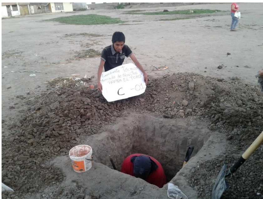
Fotografía 6: Medición de estratos de calicatas
